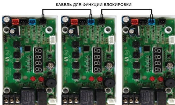
Рисунок 3-9. Электрическое подключение для функции блокировки
