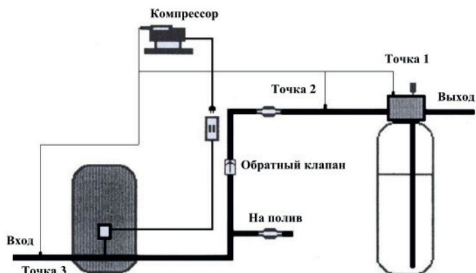
Рис.1 Варианты подачи воздуха в водопровод.
